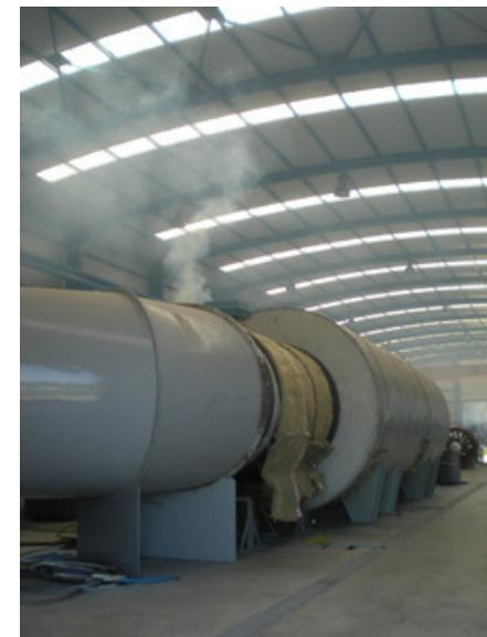
Test su ventilatore diametro 2,8 m, 300°C/2ore, doppio ventilatore / motore da 710 kW cad.
