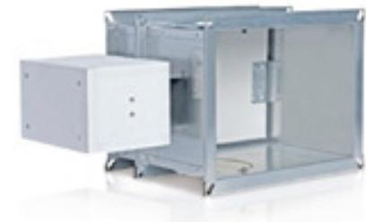
La movimentazione avviene con attuatore reversibile senza ritorno a molla. Il movimento deve essere garantito con temperature  $> 100^{\circ}\text{C}$ . L'integrità deve essere mantenuta per temperatura/tempi come da EN13501-4
