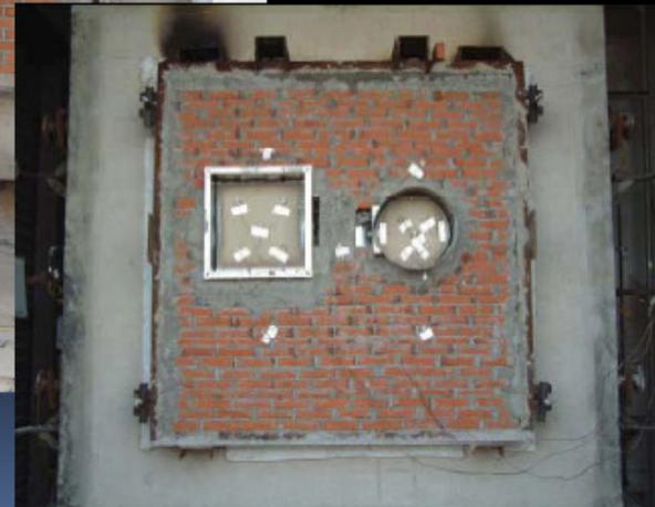
Nuova e precedente configurazione di prova: EN 1366-2 e Circolare 91
